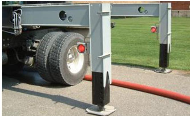
Рисунок 6. Стабилизаторы для фиксации
